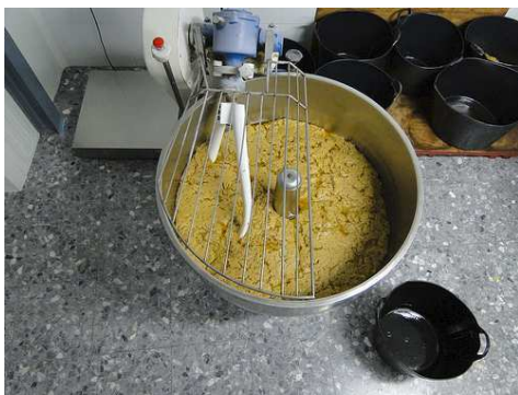
Maquinaria : amasadora de repostería. Foto: Flickr, miradas de Andalucía . Licencia Creative Commons.
