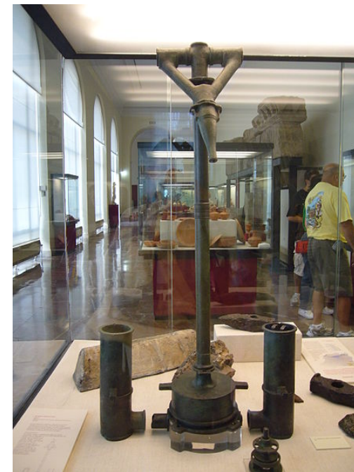
Bomba hidráulica romana de explotación minera, Sotiel-Coronada, Huelva
