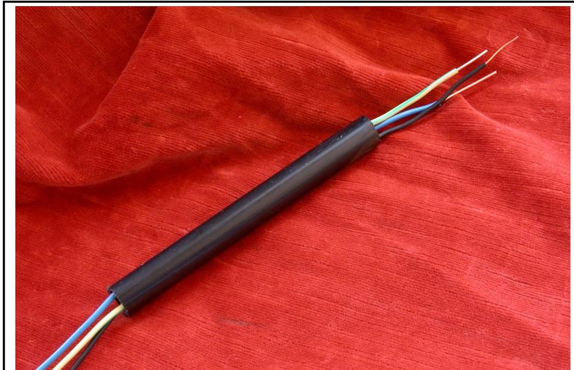
Imagen 21: Tubo protector rígido para conductores eléctricos.
