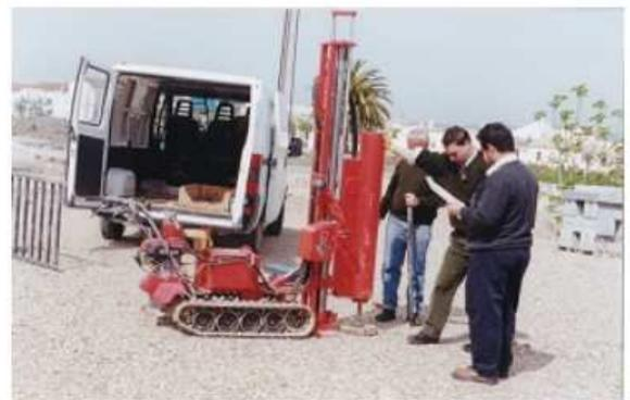
*Ensayo SPT realizado en un solar de Encinarejo (Córdoba) como parte del informe geotécnico que debe presentarse previo a la construcción de viviendas.*
