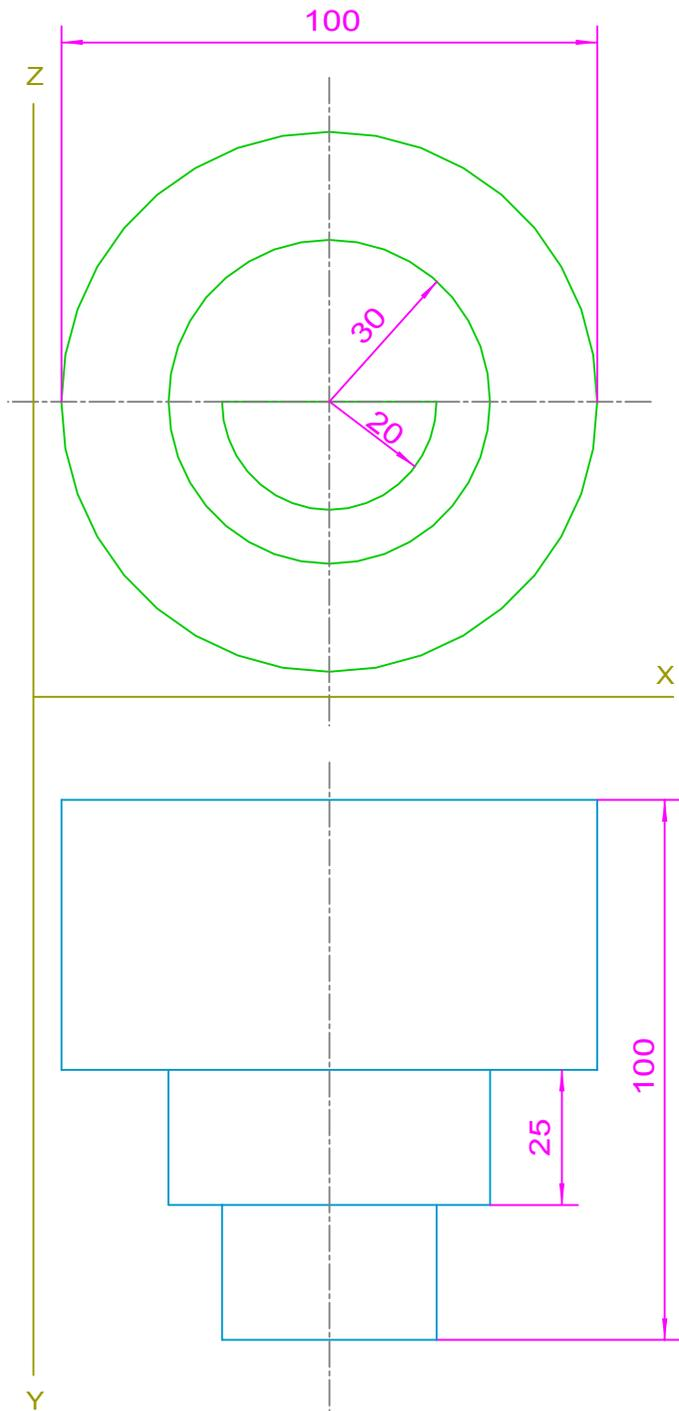
Dadas la vistas diédricas de un cilindro seccionado, apoyado en el plano XOZ
