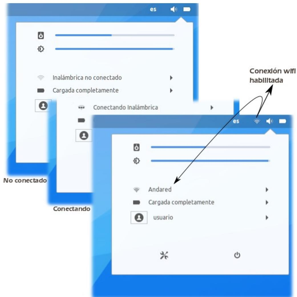
Ilustración 89. Estados de conexión inalámbrica.
