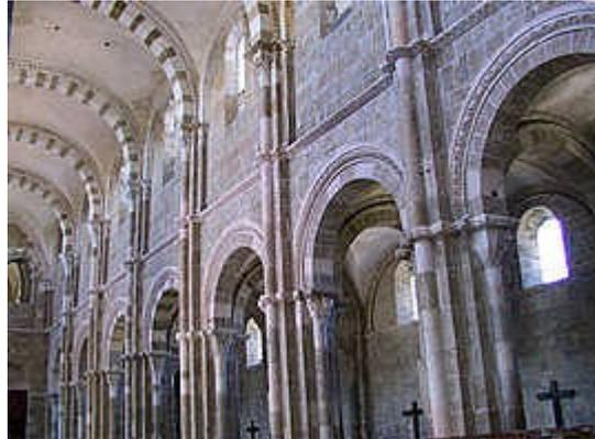
**ALZADO** con dos niveles las arquerías y el muro con vanos como fuente de la iluminación.
